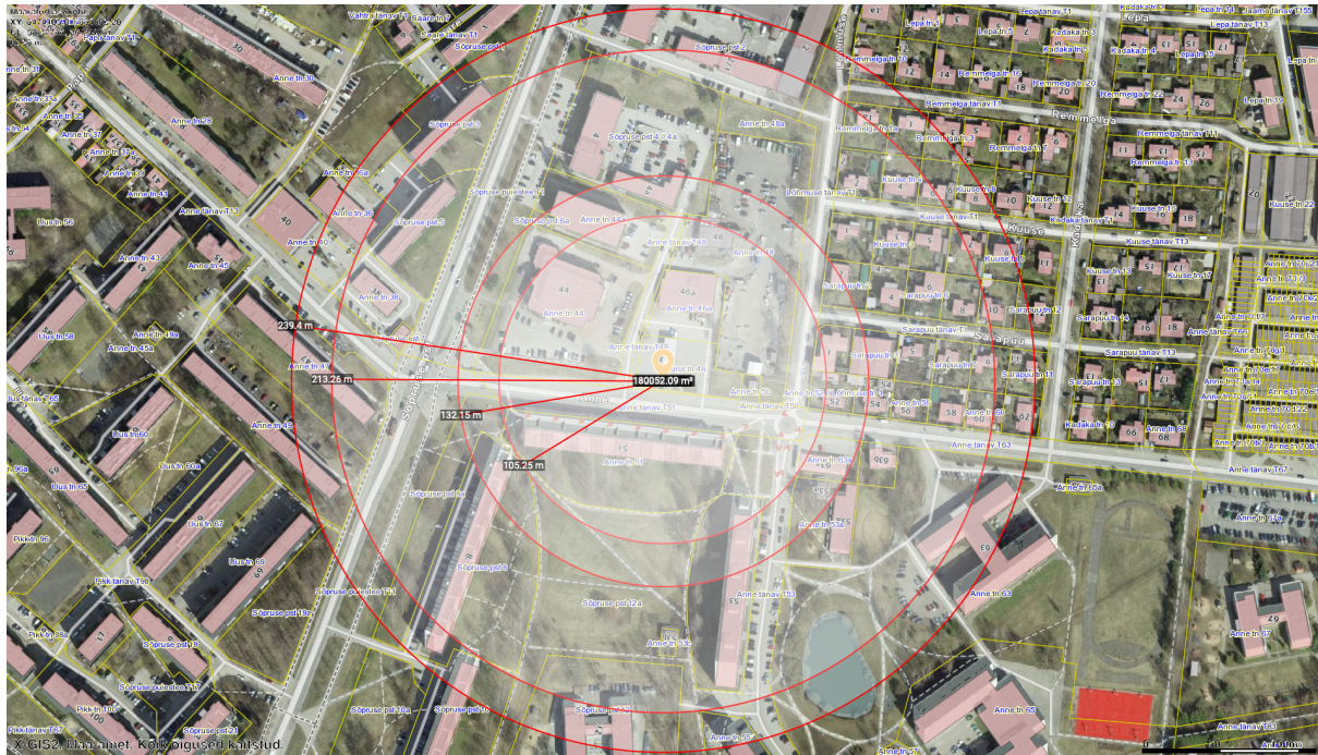
Joonis 2. Anne tankla LPG mahuti BLEVE ohualad ehitistele (Ro: 105 m) ja kaitsmata inimestele (Re: 132 m, Rv: 213 m, Ro: 239 m). Allikas: geoportaal.maaamet.ee.
